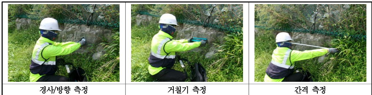
【사진 32.3.3】 불연속면 측정 현황
